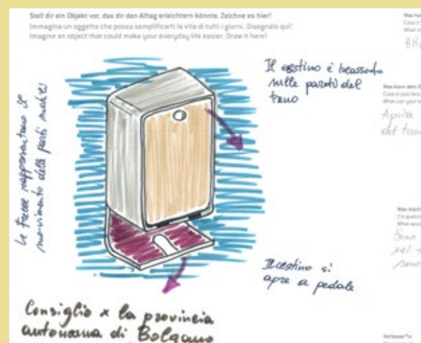
Ein sehr konkreter Vorschlag für einen fußbetriebenen Mülleimer, der in den neuen Zügen, die von der autonomen Provinz Bozen bestellt wurden, installiert werden soll.
