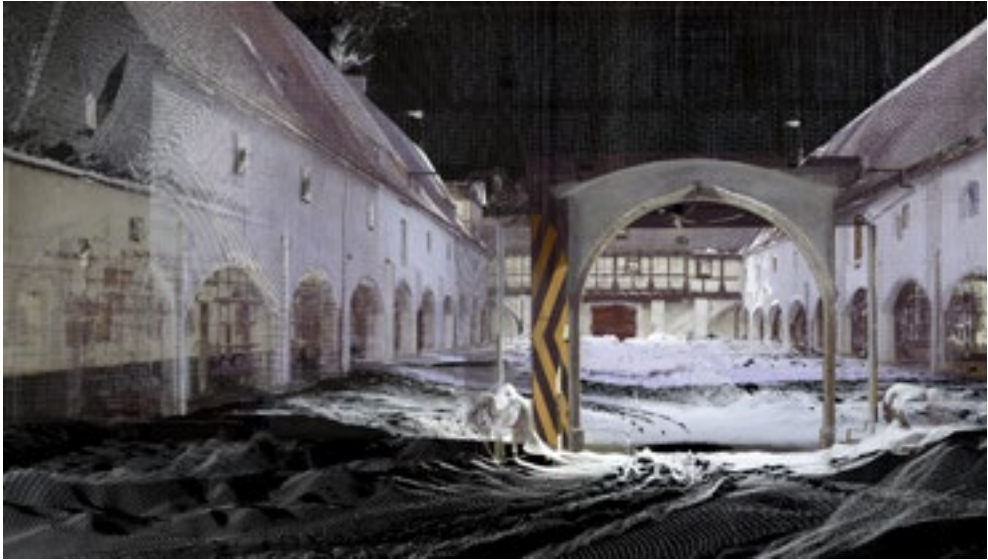
Ein terrestrischer Laserscan des Bauwerks zeigt das maximilianische Zeughaus in einem anderen Blick.
