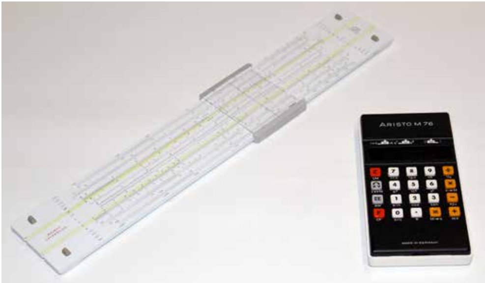
Rechenschieber „Aristo Hyperlog 0972“ und Elektronenrechner „Aristo M76“, um 1975.
