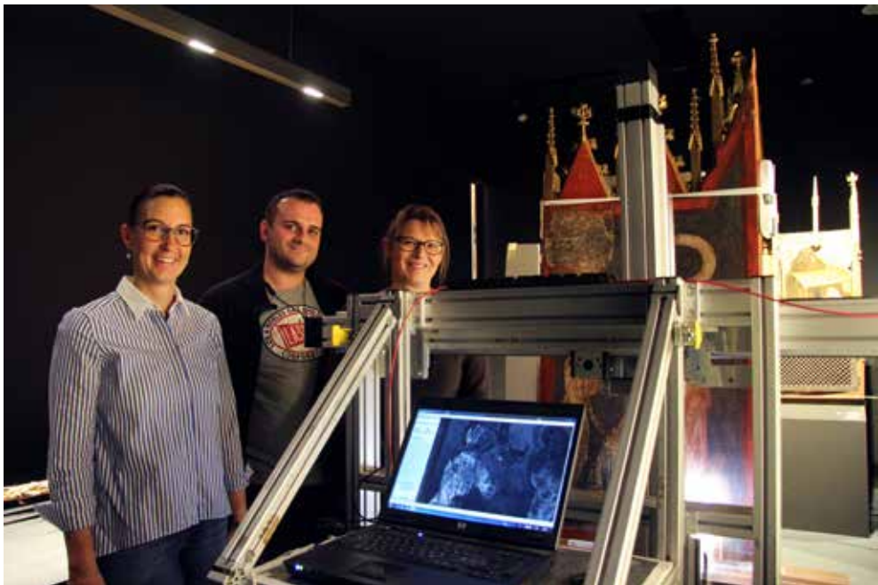
Laura Resenberg und Cristina Thieme von den Landesmuseen mit Marco Raffalli vom „Istituto Nazionale di Ottica del CNR“ am multispektralen Infrarotreflektographie-Scanner vor dem Altar von Schloss Tirol.
