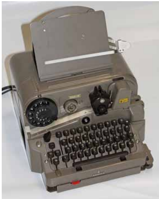
Streifen fernschreiber „Siemens 68“ mit Wähleinrichtung, um 1950.
