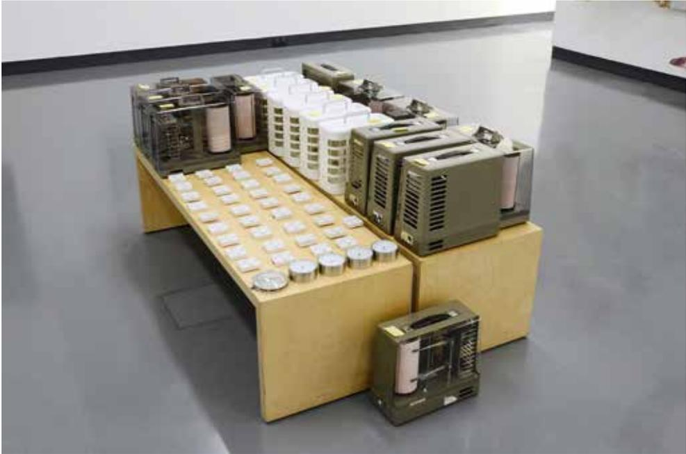
Alle mobilen Klimamessgeräte wurden zur Überprüfung der Messgenauigkeit für 24 Stunden in einem Raum aufgestellt.
