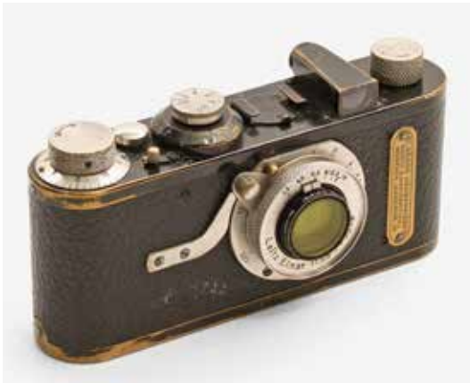
Fotoapparat „Leica I“, Kleinbild-Sucherkamera mit aufgesetztem Rohrsucher, Objektiv: Leitz Elmar, Bj. 1926 bis 1930. Foto: TLM
