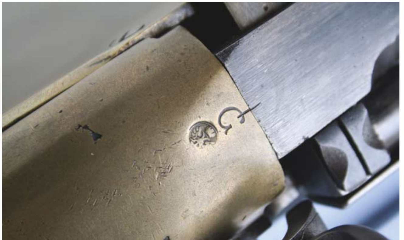
links: Seriennummer „617“, die Beschlagmarke mit dem Doppeladler und die Signatur „G“ des Büchsenmachers Bartolomeo Girandoni an der Oberseite des Schlossgehäuses.
